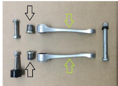
Fetten Sie die Lager und Dichtungen des **FlexibleLinkage** vor der Montage mit einem geeigneten Lagerfett.
