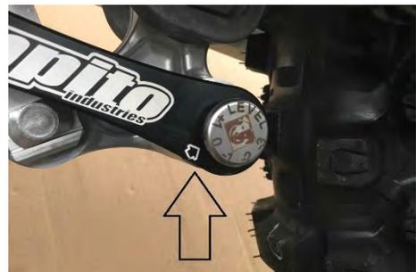
Der **FlexibleLinkage** verfügt über eine formschlüssige Arretierung der unterschiedlichen Einstellungen. Positionen: +1 0 -1 -2 -3
