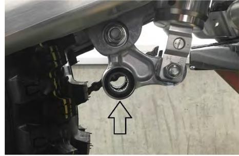
Fetten Sie die Lager und Dichtungen am Dreipunktlenker mit einem geeigneten Lagerfett und montieren Sie die Lagerbuchse und Dichtscheiben des
