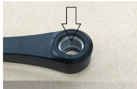
Montieren Sie die originalen Lagerbuchsen und Dichtscheiben in den **FlexibleLinkage**
