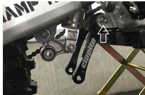
Montieren Sie die Verstelle schraube des **FlexibleLinkage** am Dreipunktlenker und sichern sie diese mit der zugehörigen Mutter.
