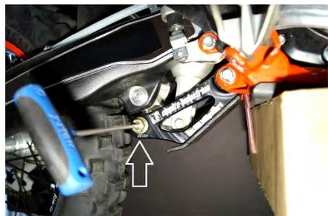
Zur Verstellung des FlexibleLinkageGuard müssen Sie nun lediglich die Mutter SW18 an der Verstelle schraube lösen und ca. 4mm von deren Anschlag freidrehen. Anschließend können Sie die Verstelle schraube aus deren Arretierung schieben und mit Hilfe eines 5er Innen-6kt-Schlüssels auf die gewünschte Position drehen. Anschließend die Verstelle schraube wieder in die Arretierung schieben.
