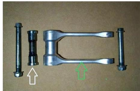
Fetten Sie die Lager und Dichtungen des **FlexibleLinkageGuard** vor der Montage mit einem geeigneten Lagerfett.
