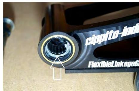
Montieren Sie die originale Lagerbuchse und Dichtscheiben in den **FlexibleLinkageGuard**
