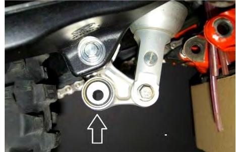
und Dichtscheiben des **FlexibleLinkageGuard** in den Dreipunktlenker. Achten Sie hierbei auf die korrekte Lage der Bauteile.
