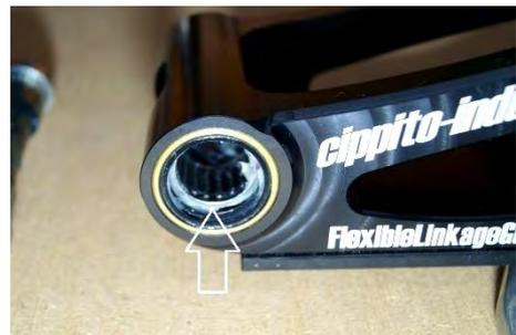
Montieren Sie die originale Lagerbuchse und Dichtscheiben in den **LoweredLinkageGuard** und montieren Sie diesen mit den originalen Befestigungsteilen am Motorrad. Die Anzugsmomente entnehmen Sie bitte der Werkstattdokumentation des Fahrzeugherstellers.
