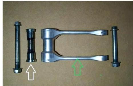
Fetten Sie die Lager und Dichtungen des **LoweredLinkageGuard** vor der Montage mit einem geeigneten Lagerfett.
