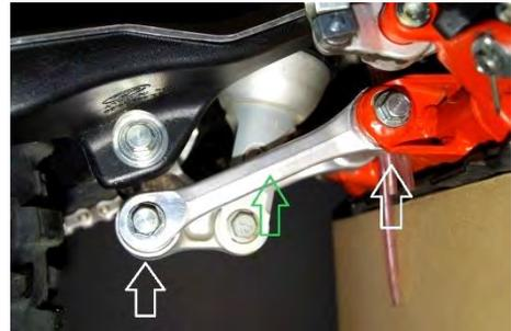
Entfernen Sie die Lagerbuchse und Dichtscheiben aus der originalen Umlenkung. Überprüfen Sie die Lagerbuchse und die Dichtscheiben auf eventuelle Beschädigungen sowie Rost und Verschleiß. Sollten die Teile Mängel aufweisen, müssen Neuteile beschafft und verwendet werden.
