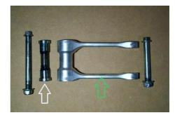
Fetten Sie die Lager und Dichtungen des Lowered Linkage führt vor der Montage mit einem geeigneten Lagerfett.
