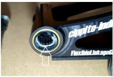
Montieren Sie die originale Lagerbuchse und Dichtscheiben in den Lowert Like und montieren Sie diesen mit den originalen Befestigungsteilen am Motorrad. Die Anzugsmomente entnehmen Sie bitte der Werkstattliteratur des Fahrzeugherstellers.
