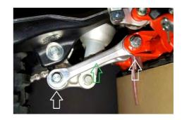
Entfernen Sie die Lagerbuchse und Dichtscheiben aus der originalen Umlenkung.
